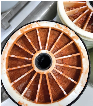
Resim 4. İçinde Biyofilm Oluşmuş Ters Ozmoz Membrani
