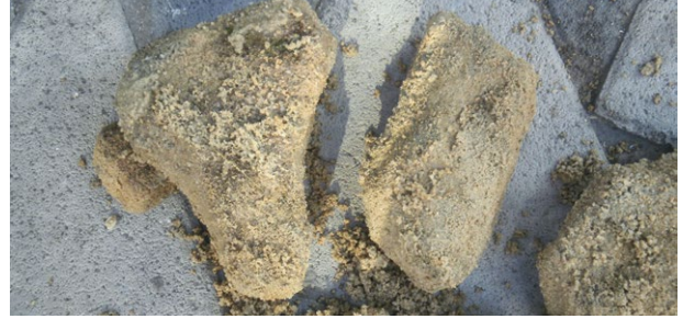
Resim 5. Mikropların oluşturduğu Biyofilm ile bloklanmış filtre kumu
