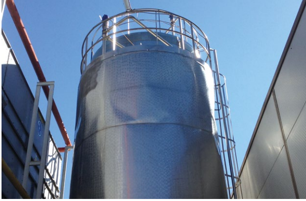
Resim 3. Vakum altında büzülmüş tank
