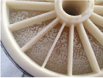
Resim 3. Suda Oluşmuş Kristaller ile tıkanmış TO membranı
