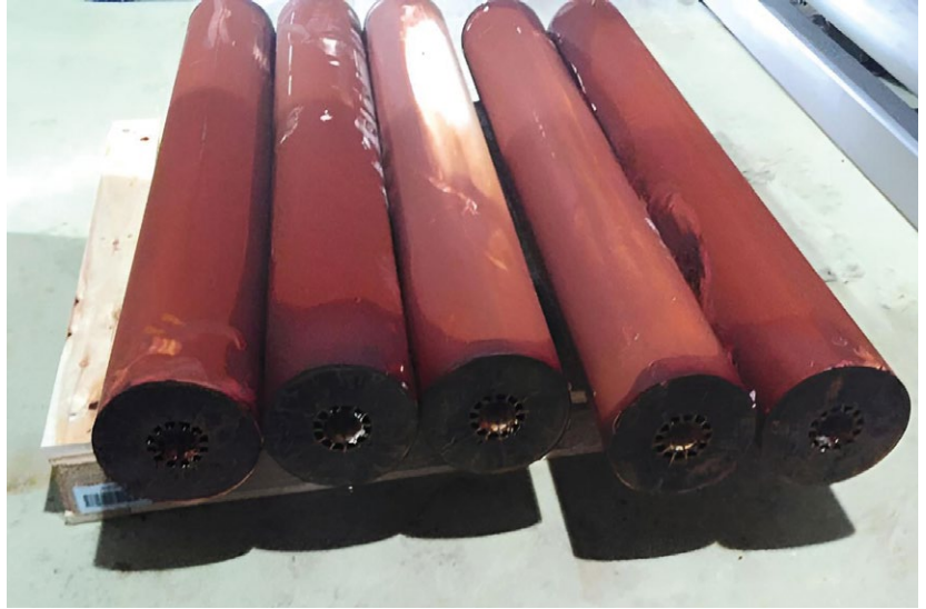
Resim 8. TO Besi Suyunda Bulunan Demir ve Mangan ile Tıkanmış Membranlar
