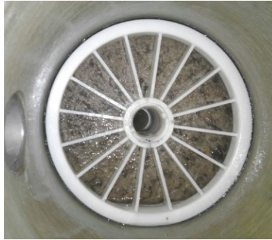
Resim 5. İçinde Biyofilm Oluşmuş TO Membranı
