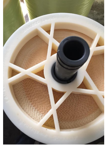
Resim 6. Klor Oksidasyonu ile Bozulmuş Membran
