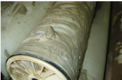
Resim 4. Yanlış Antiskalant Kimyasalı ile Tıkanmış Membran
