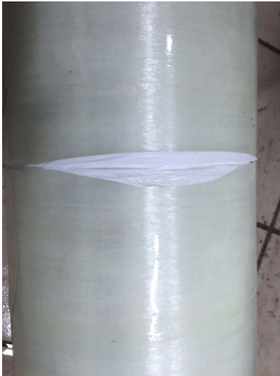
Resim 7. Çok Yüksek Basınçta Görev Yaptığı İçin Çatlamış Membran
