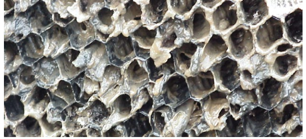
Soğutma kulesi dolgusu içinde oluşmuş biyofilm
