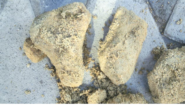
Biyofilm ile bloklanmış kum filtresi kumu
