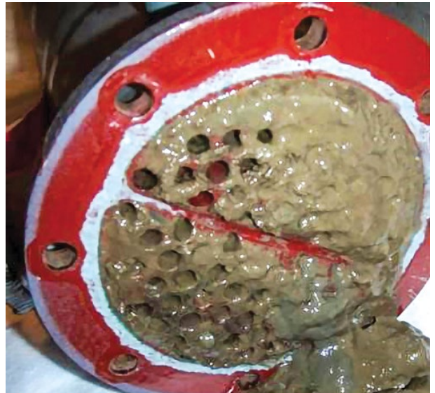
İçinde biyofilm üremiş ısı eşanjörü
