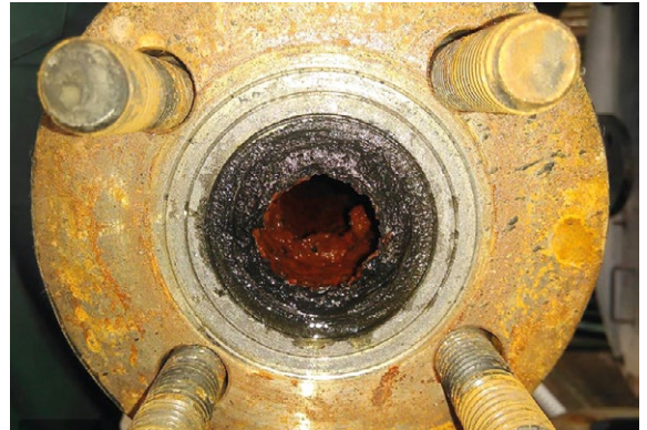
Su borusu içinde oluşmuş biyofilm tabakası
