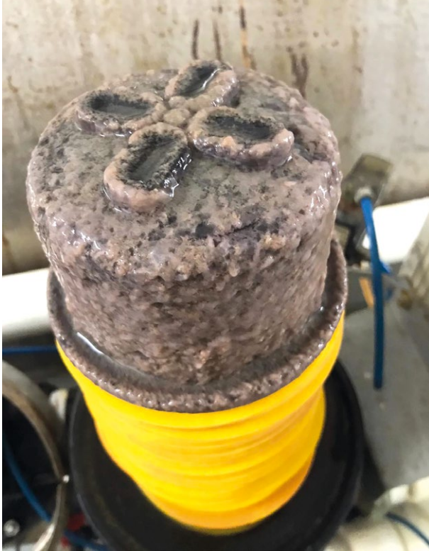
Biyofilm ile kaplanmış bir filtre
