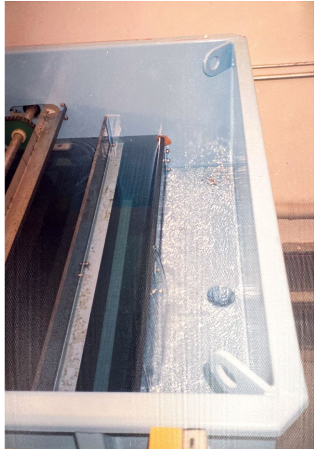
Resim 6. Kimyasal Arıtım Sonucu Boyalardan Arınmış Matbaa Atık Suyu
