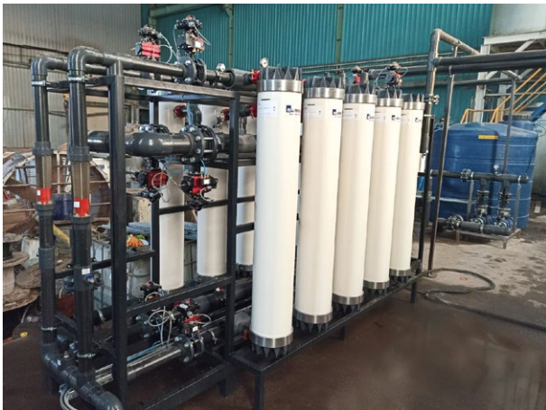
Resim 1. Su Geri Kazanım için Özel Tasarım Ultra Filtrasyon Cihazı
