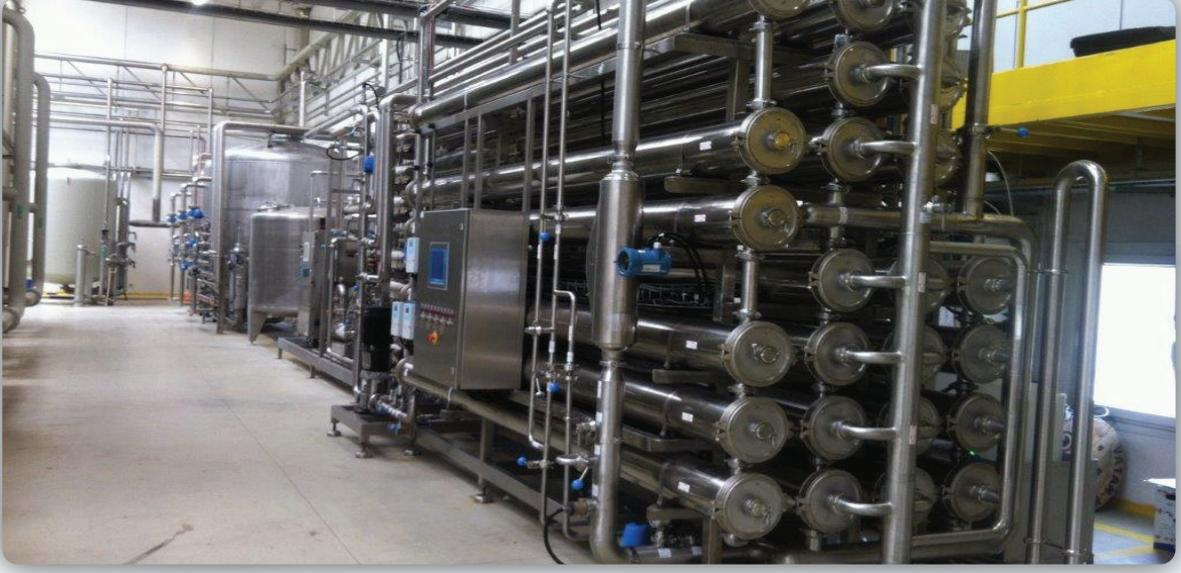
Meşrubat Suyu Hazırlama Sistemi 100 m<sup>3</sup>/saat
