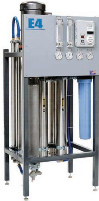
Paket tip deniz suyu T.O. cihazı, 1 m 3 saat kapasiteli
