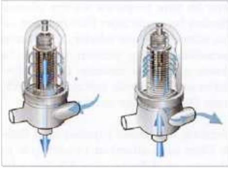
(Resim 4) Modüler Diskli Filtrenin Filtrasyon ve Ters Yıkama Konumları
