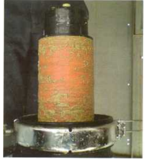
"Diskli filtre ile tutulmuş kumlar"
