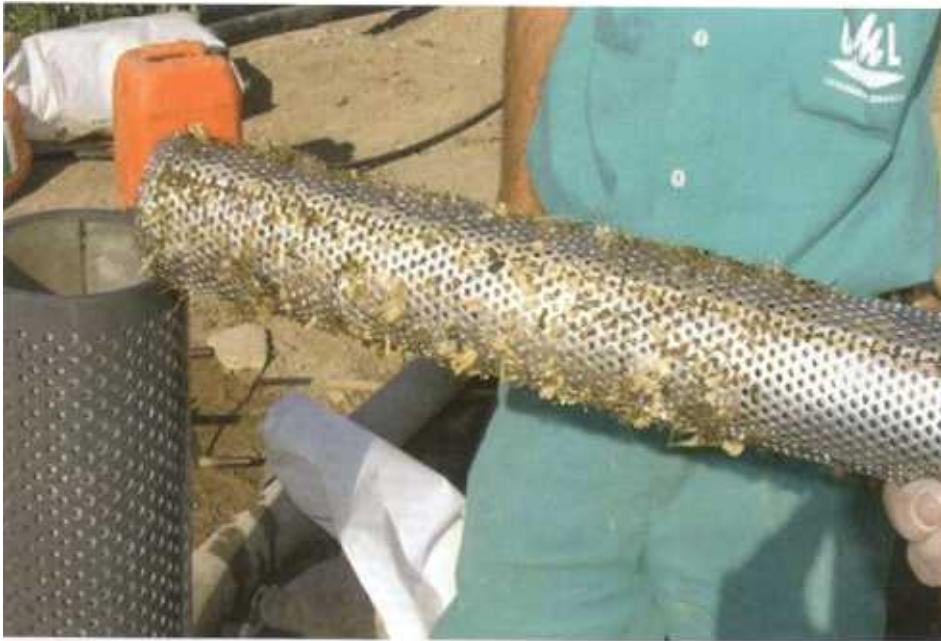
"Çok iri lifli katılar ile tıkanmış bir elek filtre"
