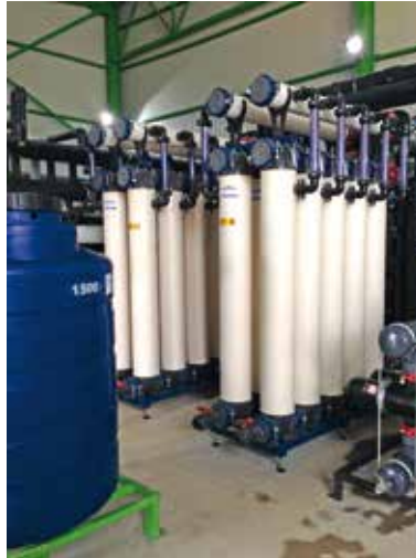
Ultra Filtrasyon Sistemi - 100 m 3 saat
