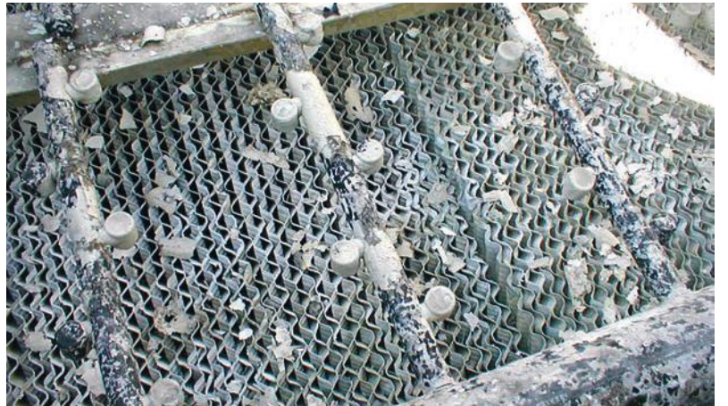
Kulenin çökmesine sebep olan kristaller
