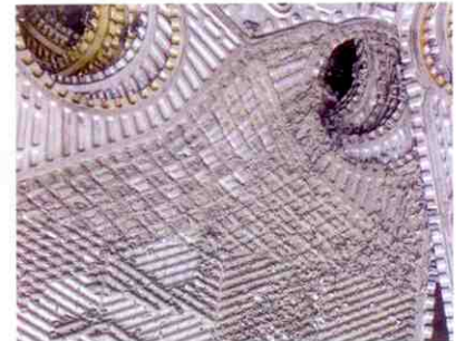
Resim 6: Plakalı ısı eşanjöründe katılar
