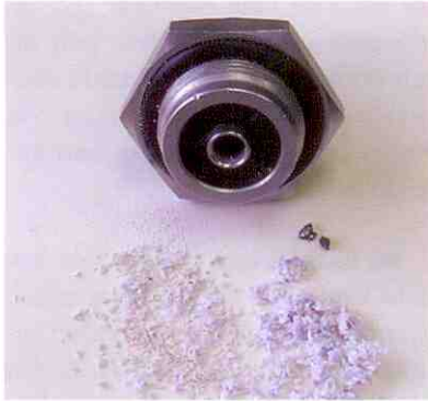
Resim 7: Tıkanan fıskiyeden çıkan katılar
