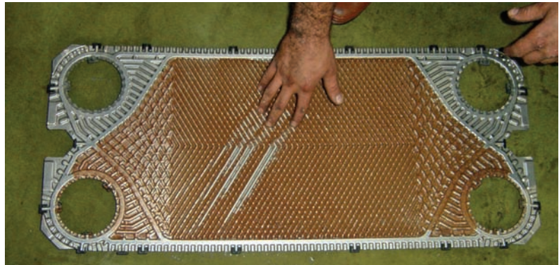
Resim 5. Kireç ve Kirlilik Sonucu Verimi Değişen Plakalı Isı Eşanjörü
