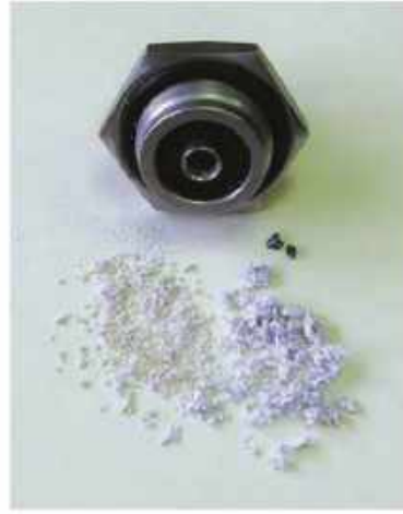
Resim 5: Tıkanan fiskiye den çıkan katılar
