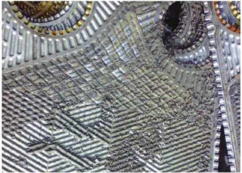
Resim 3: Plakalı ısı eşanjöründe katılar
