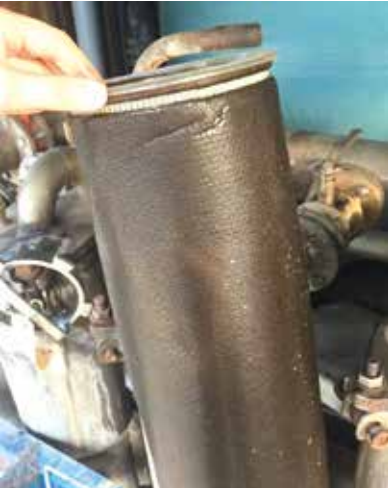
Okside Olmuş Demir ve Mangany Tutarak Doymuş Torba Filtre
