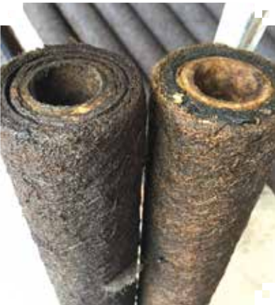
Okside Olmuş Demir ve Mangany Tutarak Doymuş Kartuş Filtreler
