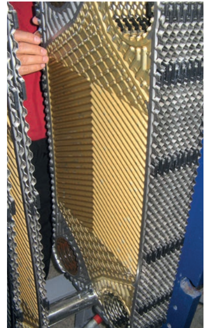
Plakalı Isı Eşanjöründe Oluşan Kristaller
