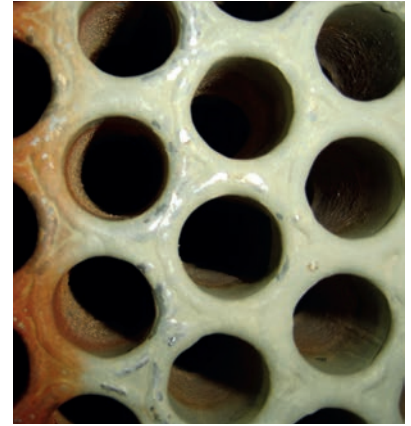
Isı Eşanjöründe Silikatın Oluşturduğu Camsı Katı Tabaka
