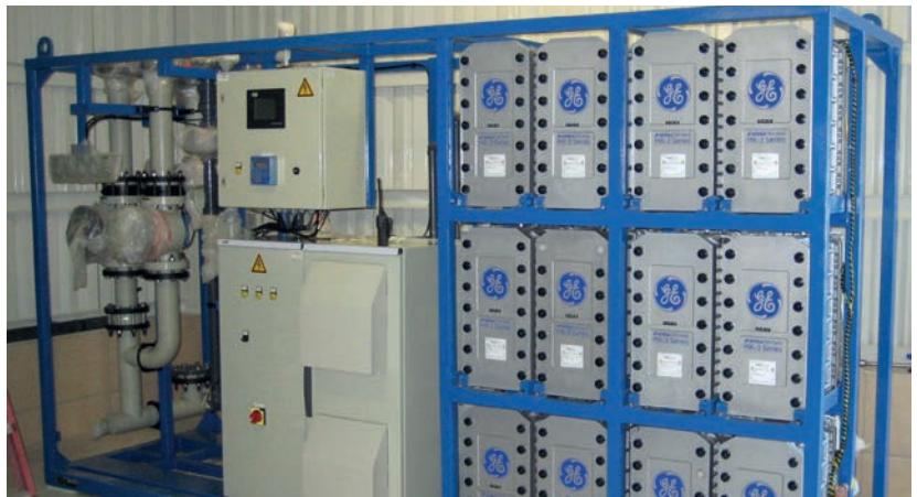
Sudaki Silikati 5 ppb Seviyesine Düşüren EDI Sistemi - 35 m 3 saat
