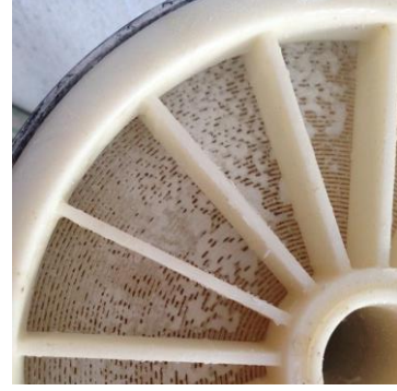
Resim 1 Kireç ile tıkanmış membran
