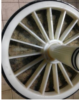
Resim 6. Mikroplar ile tıkanmış membran
