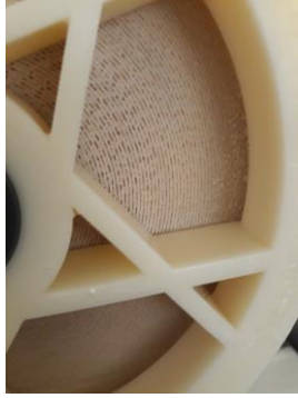
Resim 2. Antiskalant ile tıkanmış membran
