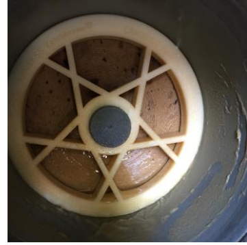
Resim 4. Çok ince katılar ile tıkanmış membran
