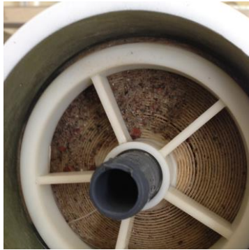
Resim 3. Katılar ile tıkanmış membran
